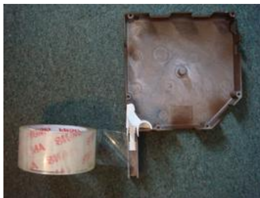
Рис. 2.2. Установка направляющего устройства в боковую крышку
